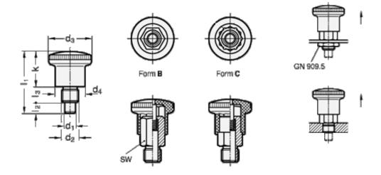
d1 = 6 Spring load initial N = 6 d2 = M10 d3 = 25 d4 = 18 k = 20.0l1 = 34.0
